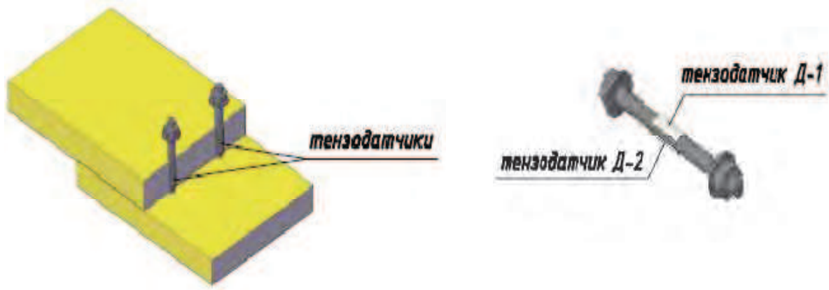
Рис. 2 – Схема розміщення тензодатчиків на болтах
