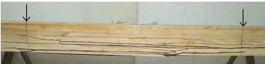
Рис. 4. Характер руйнування балки БК-А (а) та БКА-12А (б)
