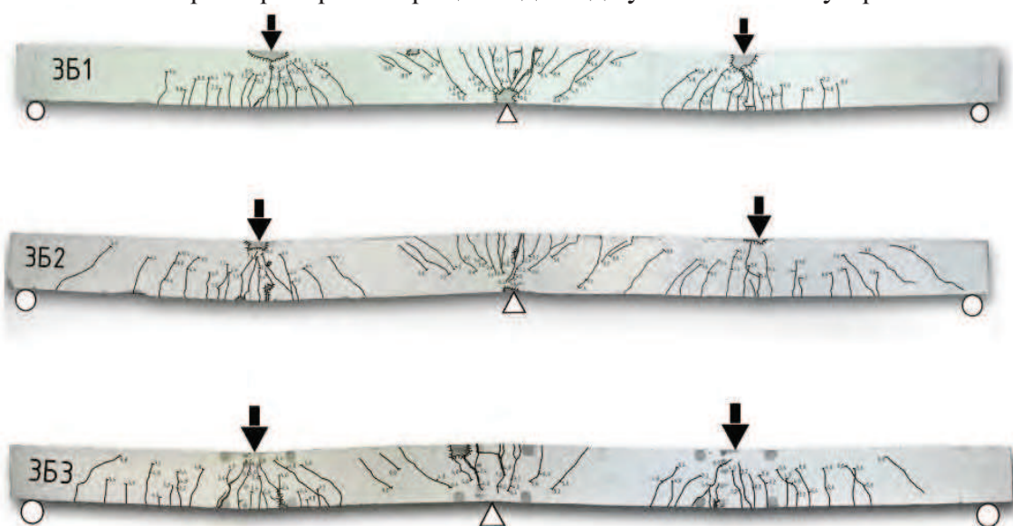
Рис. 5. Ширина розкриття тріщин в досліджуваних балках у прольотах
