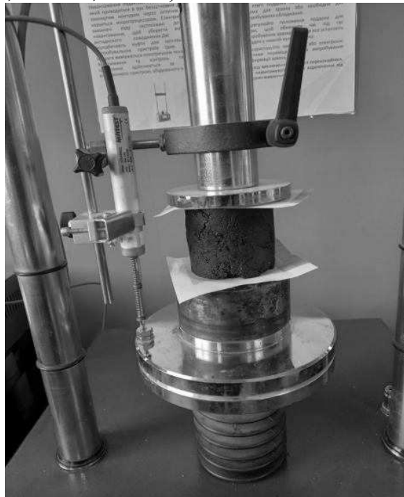
Рис. 1 Випробування стандартних зразків при одноосьовому навантаженні для визначення границі міцності при стиску
