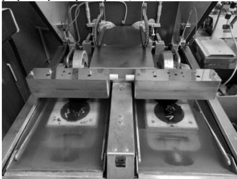
Рис. 2 Випробування зразків асфальтобетонну на утворення колії
