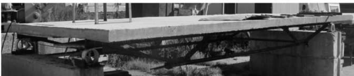
Рис. 4 – Загальний вигляд однопролітної сталезалізобетонної шпренгельної конструкції під час випробувань
