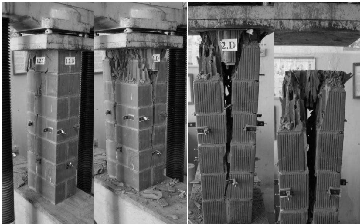
Рис. 5. Характер руйнування цегляних стовпчиків від двостороннього розколювання
