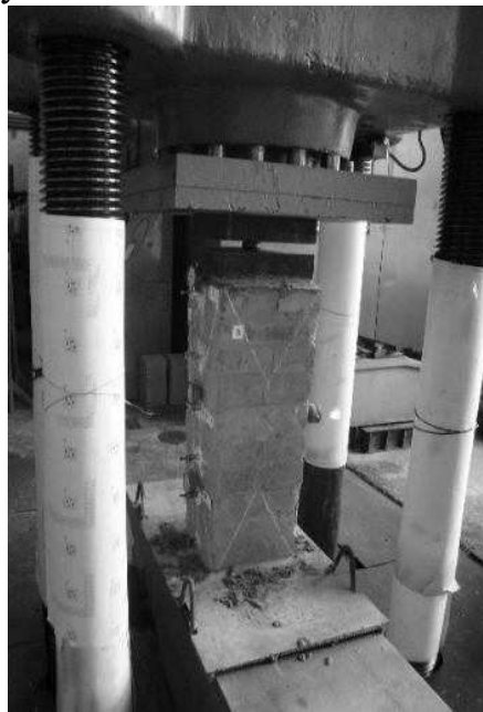
Рис. 2. Випробування цегляних стовпчиків на стиск
