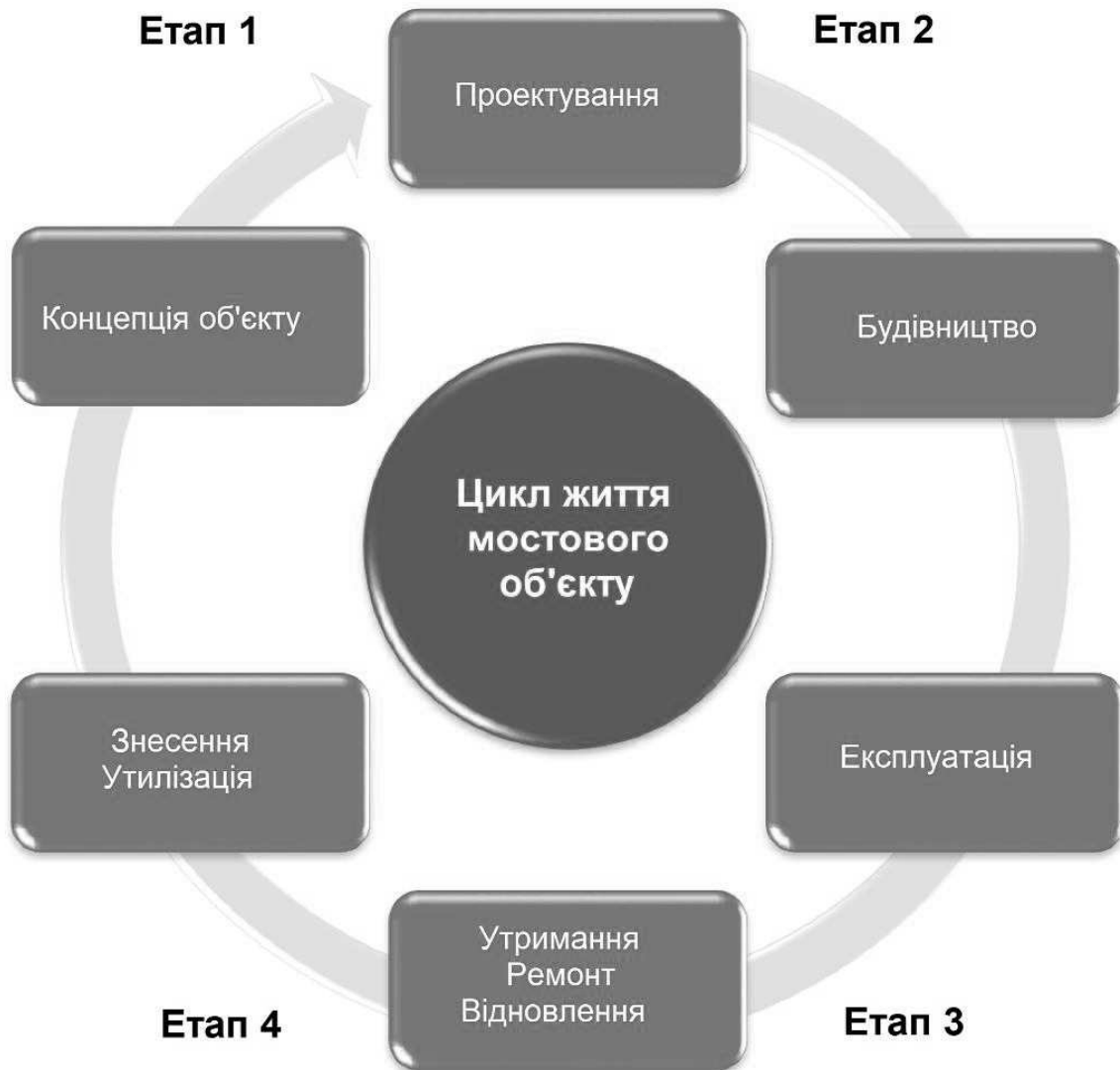
Рис.2. Цикл життя мостового об'єкту [13]
