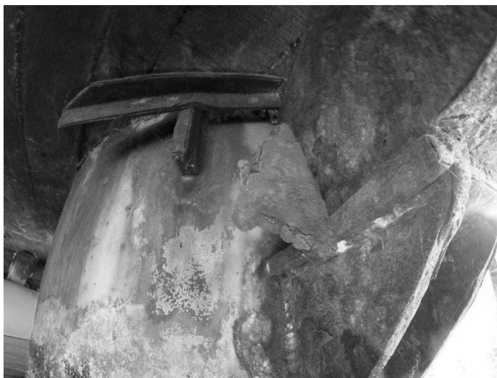
Рис. 3. Глибока корозія з розшаруванням металу
