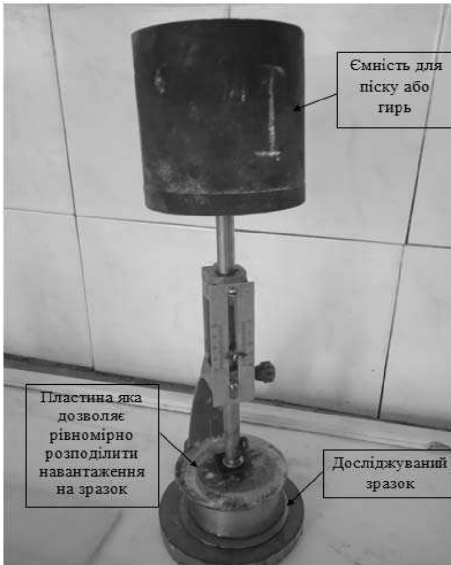
Рис 1. Прилад для визначення структурної міцності бетонів.
