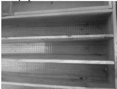
Рис. 2. Форми для виготовлення дослідних балкових зразків із вкладеним нетрадиційним армуванням
