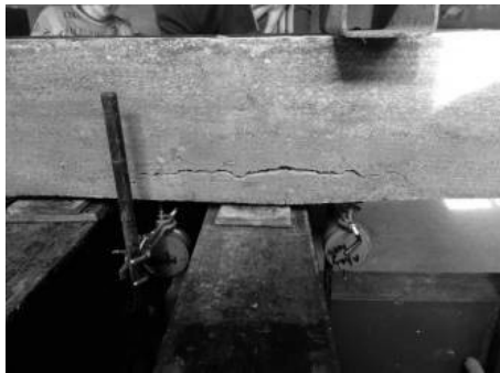
Рис. 5. Горизонтальна тріщина у дослідному зразку
