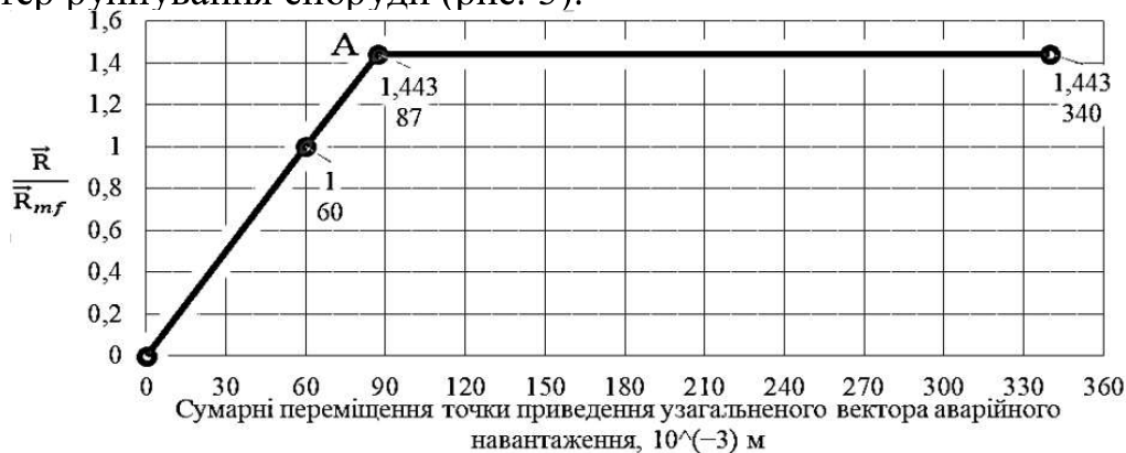
Рис. 3. Діаграма переміщення точки приведення головного вектора аварійного навантаження (розрив верхнього канату) в процесі пружно-пластичного аналізу: \bar{R} – змінне значення головного вектора аварійного навантаження; \bar{R}_{mf} – граничне розрахункове значення головного вектора від розриву підйомного канату
