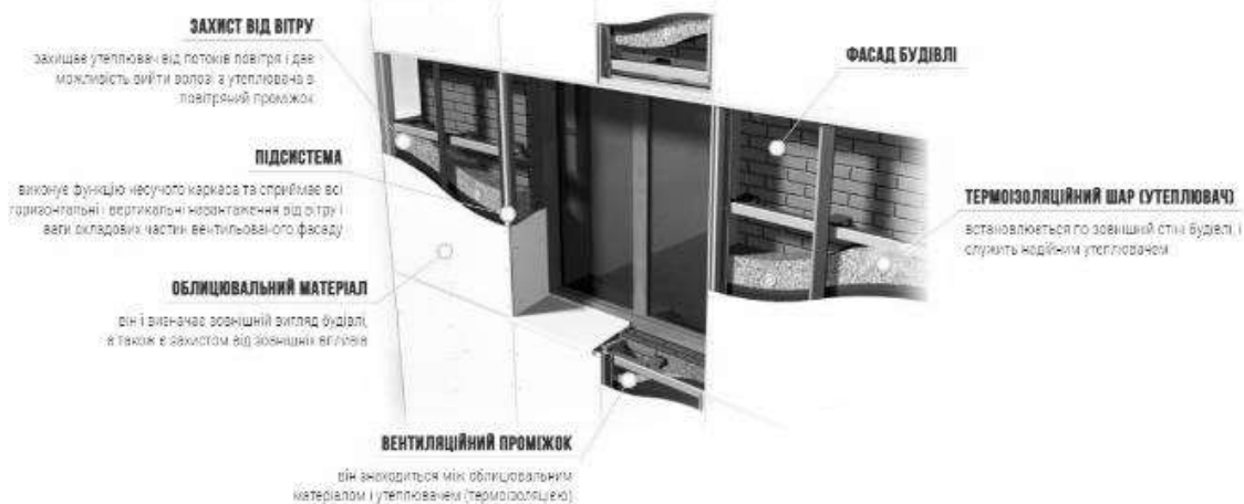
Рис. 3. Система вентилязованого фасаду
