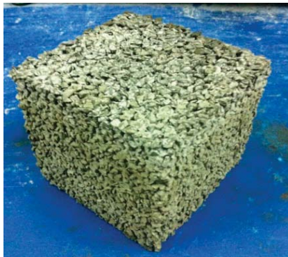
Рис. 1. Лабораторний зразок крупнопористого бетону з гранітного відсіву
