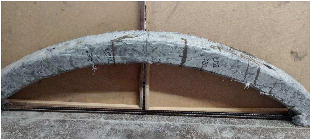
Рис. 8. Вигляд арки з контурами тріщин після випробування
