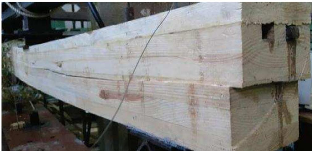
Рис. 8. Характер руйнування досліджуваної балки з попередньо-напруженою композитною арматурою
