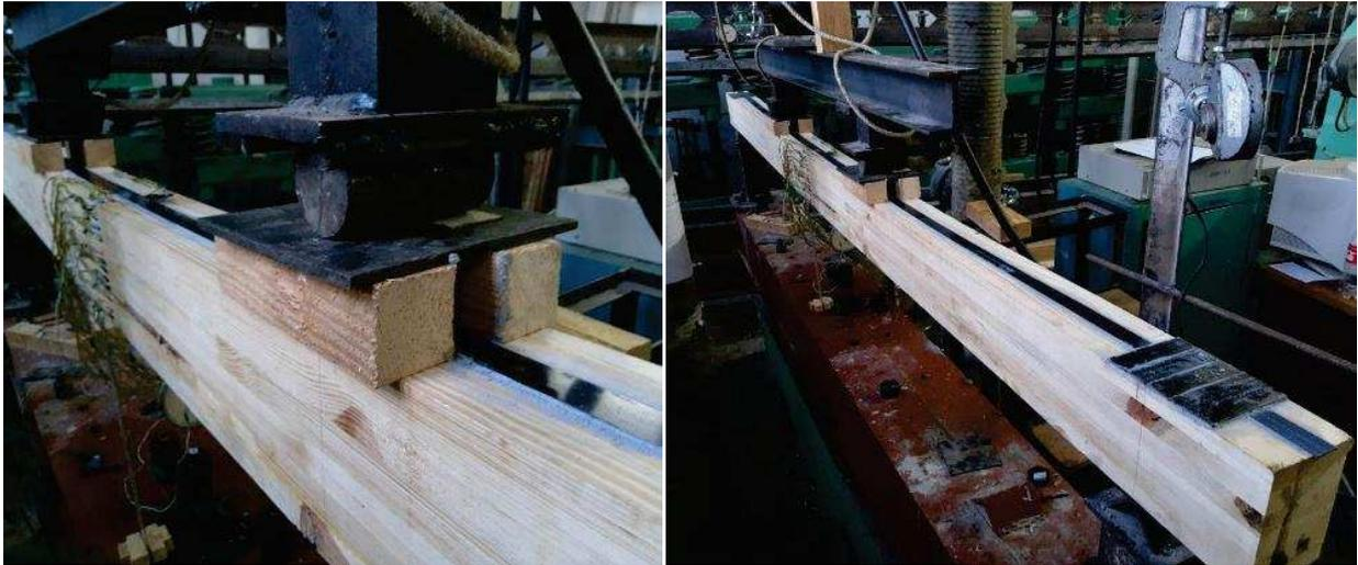
Рис. 4. Приклеювання стрічки під навантаженням
