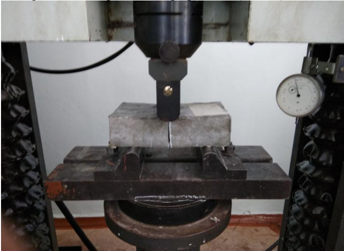
Рис.1. Експериментальне отримання діаграм деформування бетону на балочках
