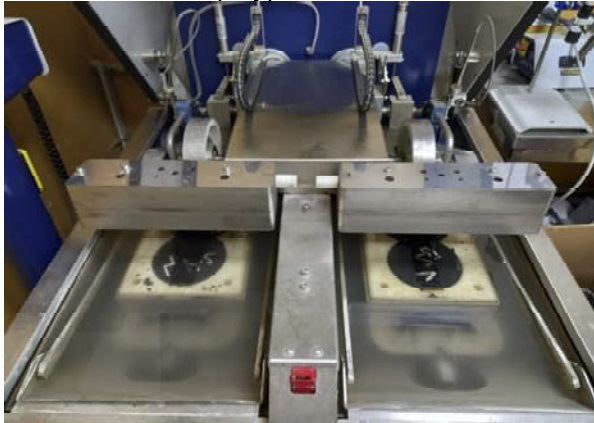
Рис. 2. Прилад Matest SMARTRACKER™ - Multi wheels hamburg wheel tracker для дослідження колісстворення
