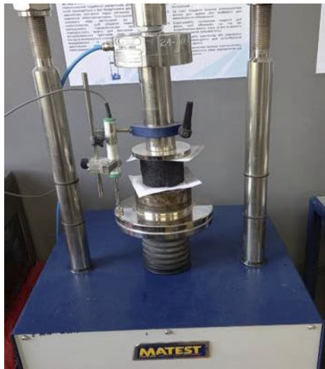
Рис. 1. Універсальний тестер ( S215A Universal multispeed load frame, 50 kN digital measurement, Matest, Італія)
