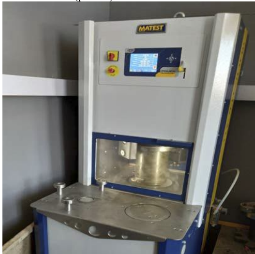
Рис. 3. Гіраторний компактор з формування зразків для визначення колійності
