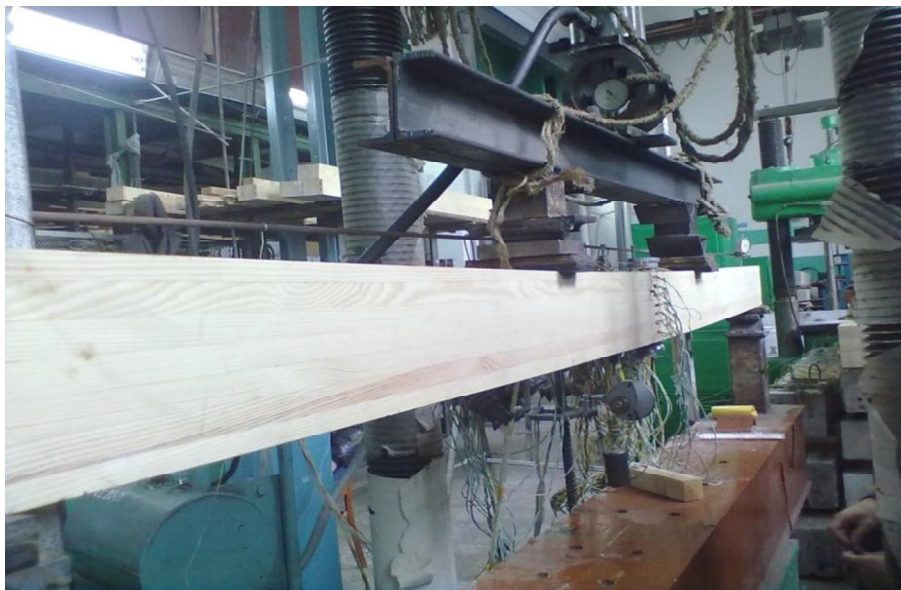
Рис. 3. Загальний вигляд дослідної установки при випробуваннях балок на поперечний згин
