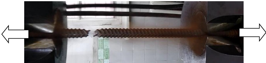
Рис. 2 – Вигляд зразка \text{Ø}25 мм у момент розриву під час випробувань
