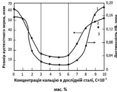
Рис. 4. Вплив концентрації кальцію на розмір аустенітного зерна та дисперсність неметалевих включень
