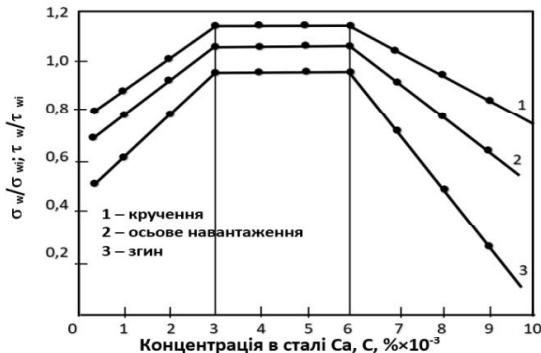
Рис. 2. Відношення спротиву втомності на базі N=10^7 циклів в соляній воді (5% NaCl) при випробуванні на кручення (1), осьове навантаження (2) та згин (3) Примітка: \sigma_w ( \tau_w ) - спротив втомленості на базі 10^7 циклів; \sigma_{wi} ( \tau_{wi} ) - спротив втомленості на базі 10^7 циклів в іонообмінній воді
