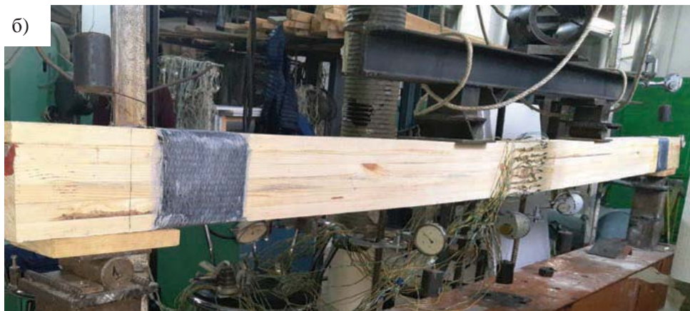
Рис.2 Схема навантаження досліджуваних зразків - а), загальний вигляд армованої балки під навантаженням - б)
