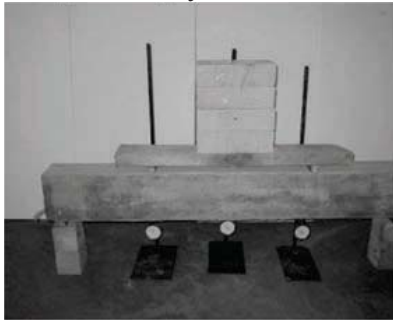
Рис. 3. Розташування балки на дослідному стенді та завантаження пінобетонних балкових зразків цеглинами
