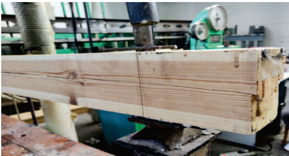
Рис. 10. Руйнування балки з цільної деревини SBR45(Prst) за рахунок сколювання деревини по площині вздовж елемента поблизу нейтральної лінії
