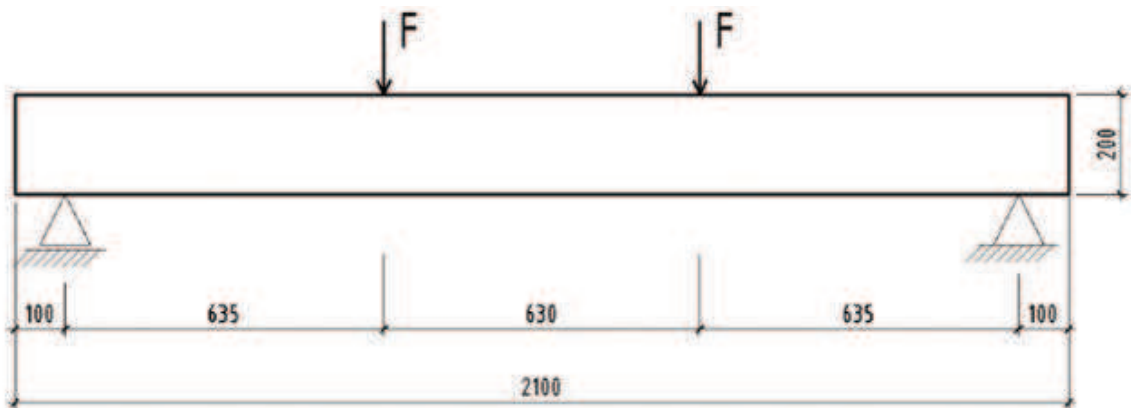
Рис. 5. Схема прикладання навантаження
