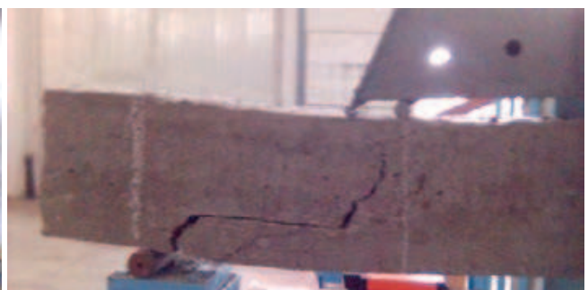
Рис. 3 – Загальний вигляд типового руйнування балок за похилою тріщиною по контактному шву
