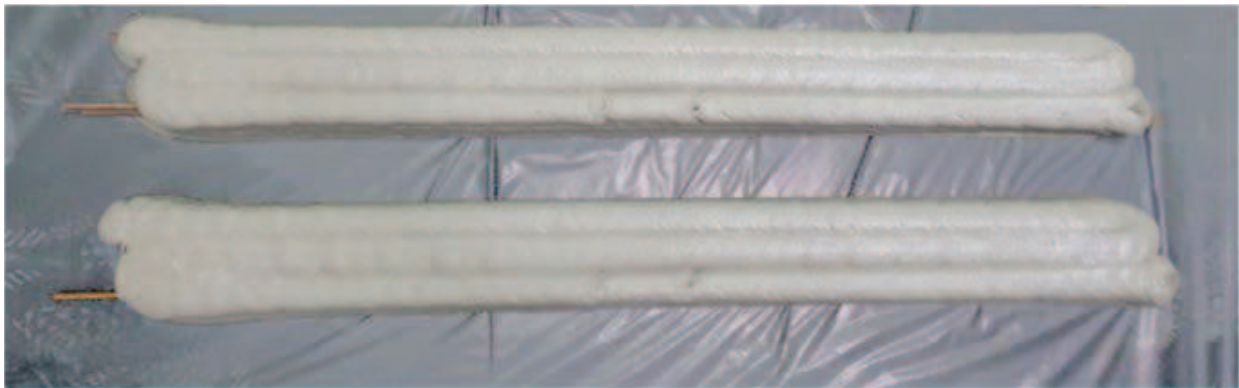
Рис.5. Конструкція арки, після завершення робіт методом 3D друку
