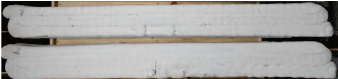
Рис. 7. Балки виготовлені методом 3D друку, після досягнення проектної міцності.
