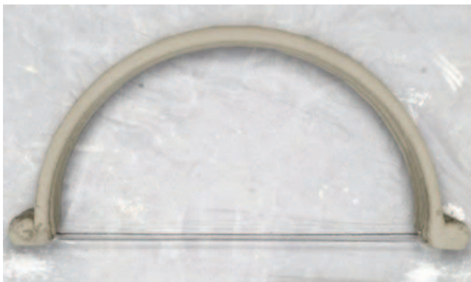
Рис.5. Конструкція арки, після завершення робіт методом 3D друку
