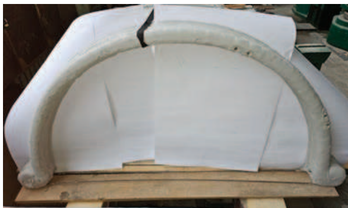
Рис. 7. Арка, виготовлена методом 3D друку, після досягнення проектної міцності.
