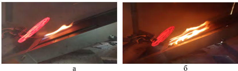
Рис. 2. Результати досліджень процесу займання та поширення полум'я по поверхні зразка термічно модифікованої деревини: а – займання зразка; б – поширення полум'я поверхню
