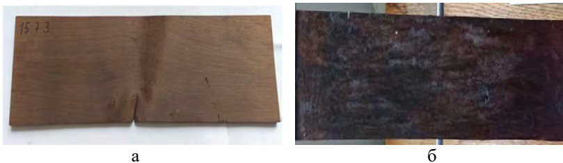
Рис. 1. Зразок термічно модифікованої деревини: а – необроблений; б – вогнезахиснений інтумесцентним покриттям
