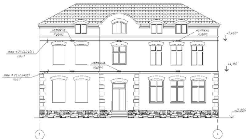
Рис. 4. Розміщення металевих тяжів на фасаді
